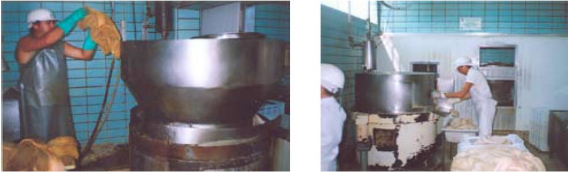
FIGURA: 23 e 24- Carga e descarga da máquina lavadora de buchos. (Fonte: SÃO PAULO, 2006).
