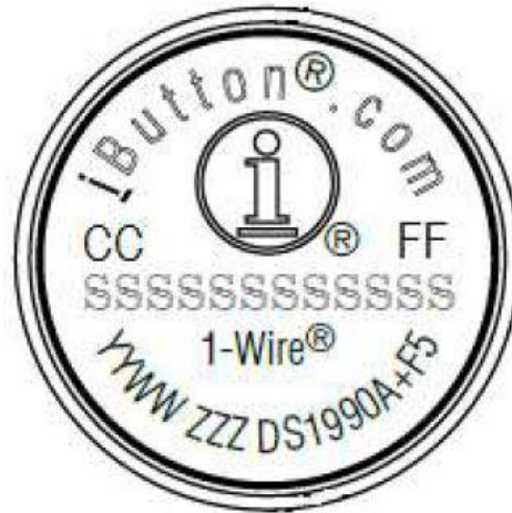
FIGURA 02: Informações gravadas no encapsulamento do iButton.
